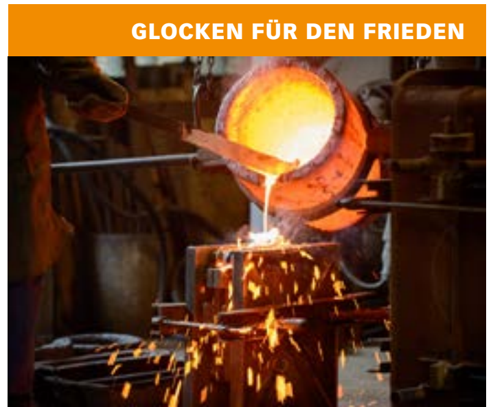
Glockenguss in der Firma Rüetschi. (Fotos: © Fa. Rüetschi, Aarau)
