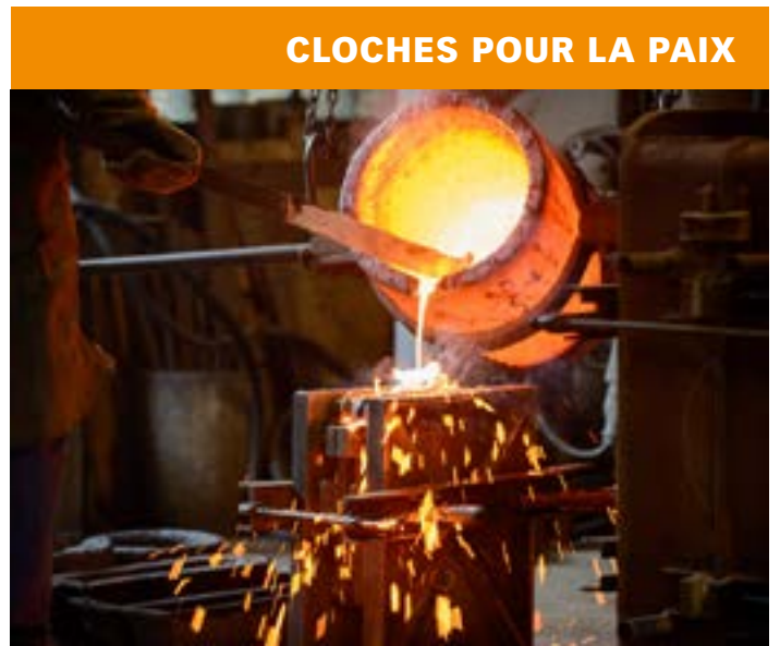
Fonte de cloches dans l'entreprise Rüetschi. (photo: © Rüetschi, Aarau)
